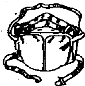
图 5-3 BL-80J 型 矽尘、 500\text{mg}/\text{m}^3 以下的煤尘和 300\text{mg}/\text{m}^3 以下水泥尘及其它无毒粉尘的场所,但不适用于含有毒气体或含氧量不足18%的场所。
